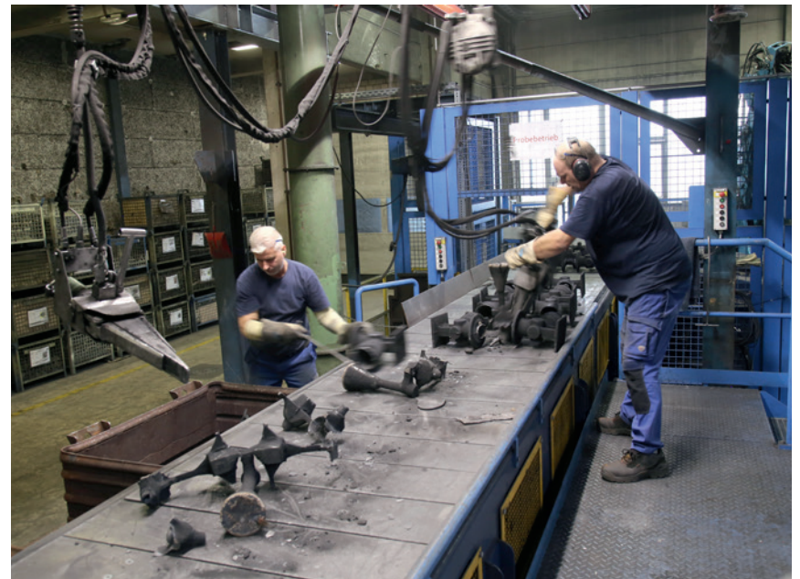
AUMUND flat plate conveyor in a German foundry. AUMUND-Flachplattenband im Einsatz in einer Gießerei in Deutschland. (Photo: AUMUND)
