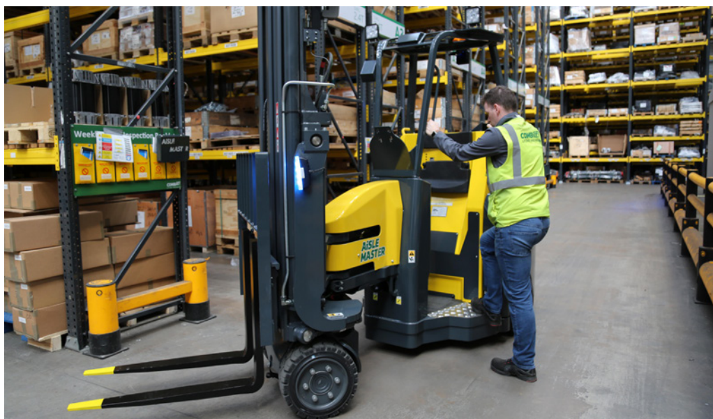
Die niedrige Flurhöhe von nur 280 mm ermöglicht einen bequemen, einstufigen Zugang von beiden Seiten des Staplers (Foto: Combilift)
