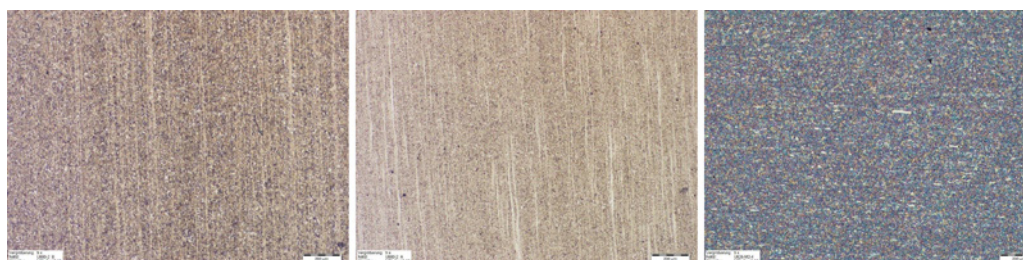
Bild 1. Gefügebilder von niedriglegiertem Vergütungsstahl 1.8714 (links), Manganhartstahl 1.3401 (Mitte) und KV1+ mit homogener Walztextur (rechts) (Bild: Friedr. Lohmann GmbH)
