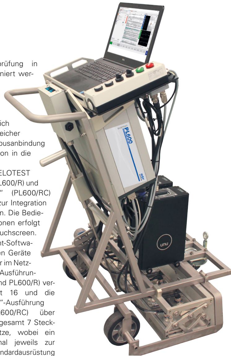
ELOTES PL600 – Digitales Wirbelstrom-Prüfgerät (Bild: Rohmann GmbH)
