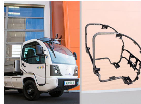
Wuppermann produziert den Kabinenrahmen für vollelektrische Kommunalfahrzeuge des österreichischen Start-Ups MUP (Foto: Wuppermann)
