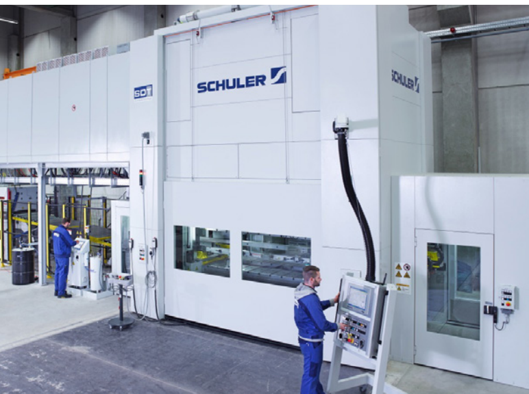
Die Servopresse wird am Anfang einer Produktionslinie stehen, zu der auch eine Profilier- sowie eine Schweißanlage gehören (Foto: Schuler)
