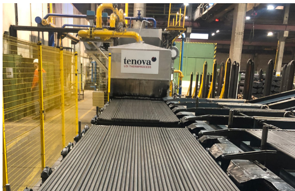
Kaltgezogener oder geschälter Automatenstahl wird im Durchlaufofen weichgeglüht, um eine geringe Koerzitivfeldstärke zu erreichen (Foto: Steeltec)
