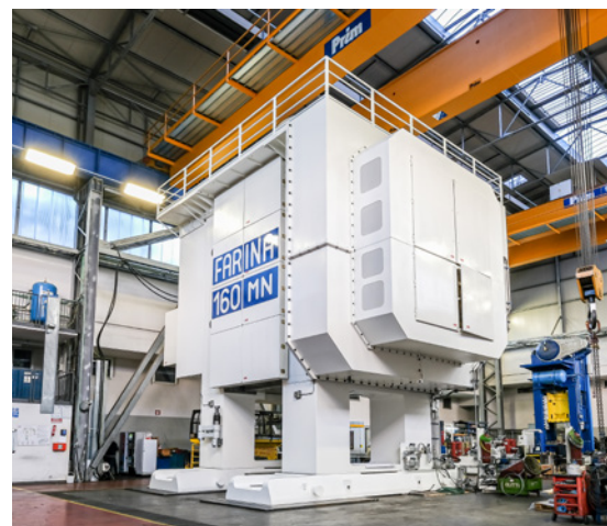
Mit 16.000 Tonnen Presskraft eine der weltweit größten mechanischen Schmiedepressen (Foto: Schuler)
