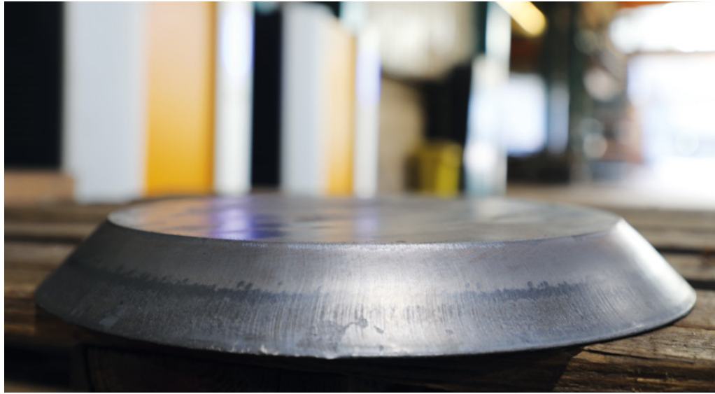
Ein sauber gefertigter Brennschnitt ist Voraussetzung für eine effiziente Weiterverarbeitung (Foto: Susanne Czaika)
