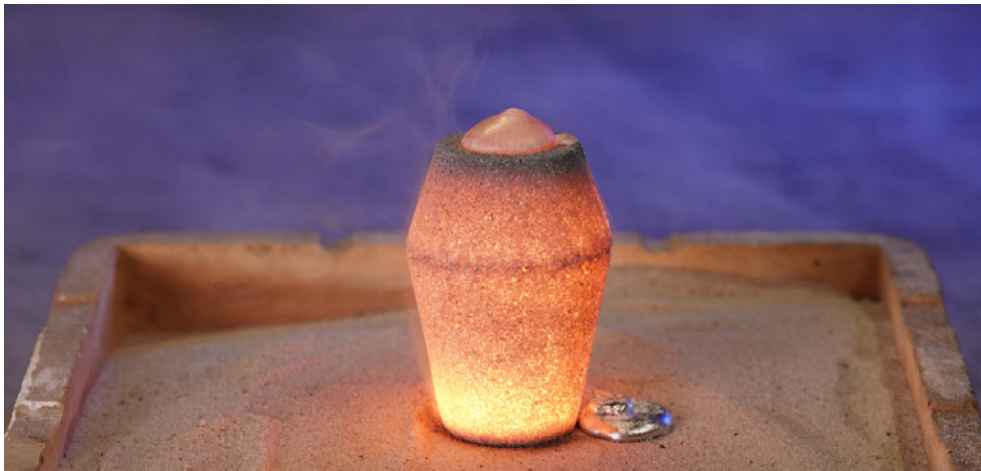
FEEDEX NF1 feeding technology for aluminium foundries. FEEDEX NF1 Speisertechnik für Aluminiumgießereien. (Photo: Foseco International Ltd.)
