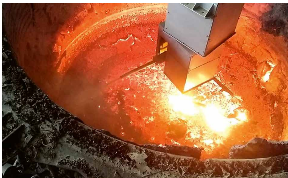
Spritzroboter Hytop bei der Heißreparatur eines EAF (Bild: Velco)
