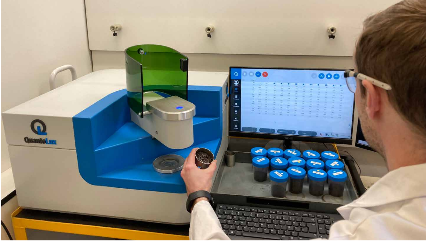
Mit Laser-OES lassen sich 15 Proben in unter 10 Minuten analysieren (Bild: QuantoLux)
