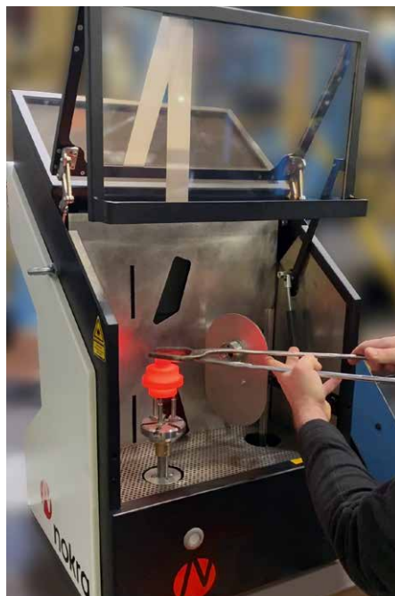
In der Messzelle wird das Schmiedestück auf dem Drehteller platziert, der während der Messung rotiert (Foto: nokra)
