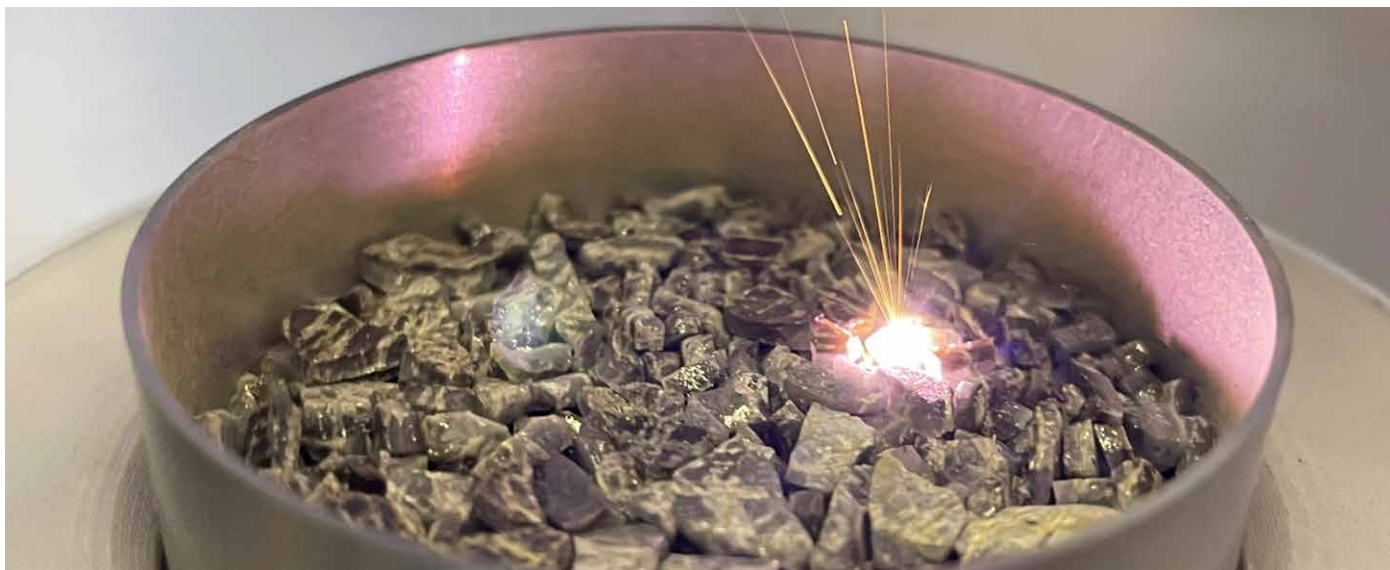
Laser-OES-Plasma auf einer sekundärmetallurgischen Schlackenprobe (Bild: QuantoLux)
