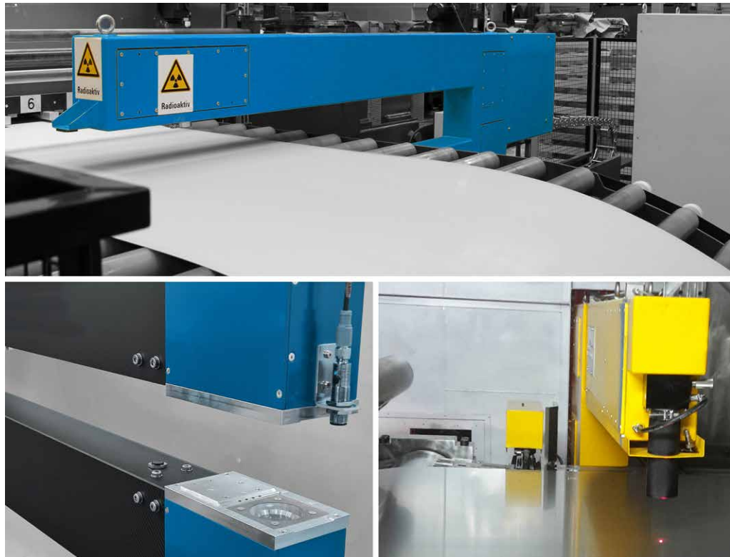
EMG iTiM Dickenmesssystem Isotopen-, Laser- und Röntgentechnologie (Bild: EMG)
