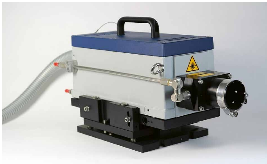
Surface Velocimeter in einem Kühl- und Schutzgehäuse auf einer Justier- und Montageplattform (Foto: Polytec)
