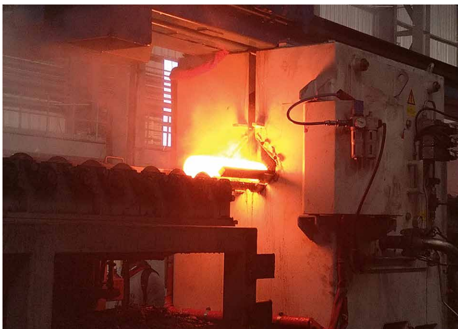
Die neue „Microline Descaling Anlage“ bei Happy Forgings (Foto: SGGT Hydraulik)
